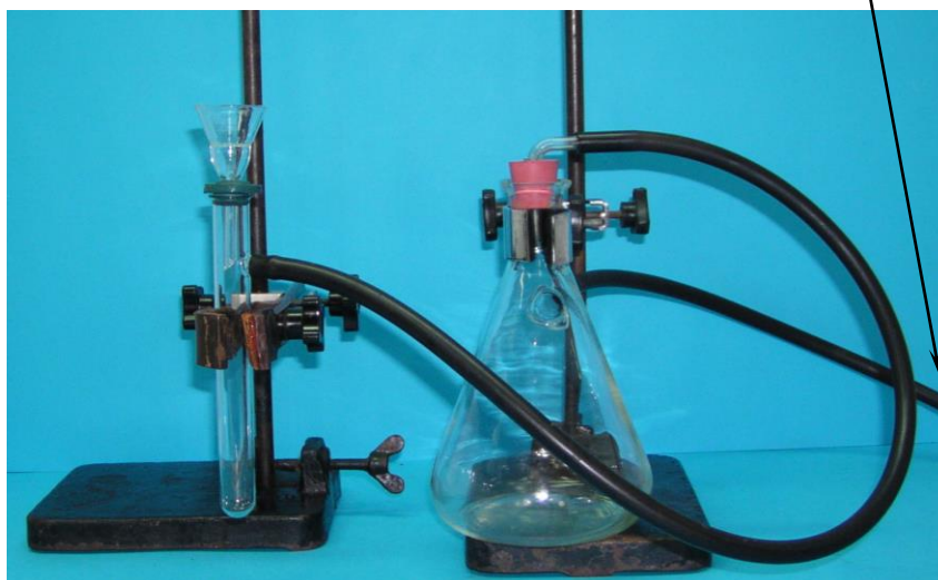
Zestaw do sączenia pod zmniejszonym ciśnieniem małych ilości osadu
